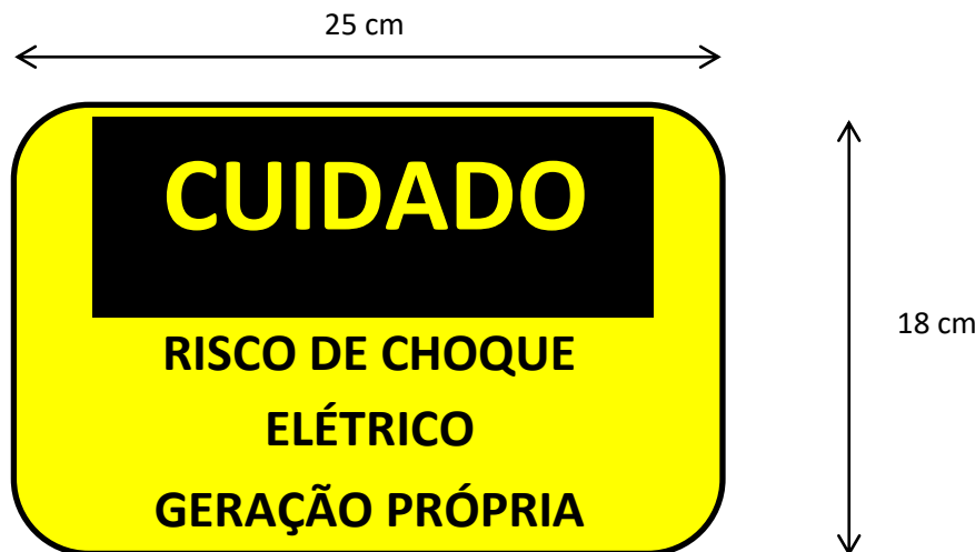
Figura 2 - Placa de sinalização
